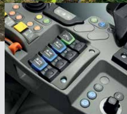
*Distributeurs hydrauliques à commande électronique.*
